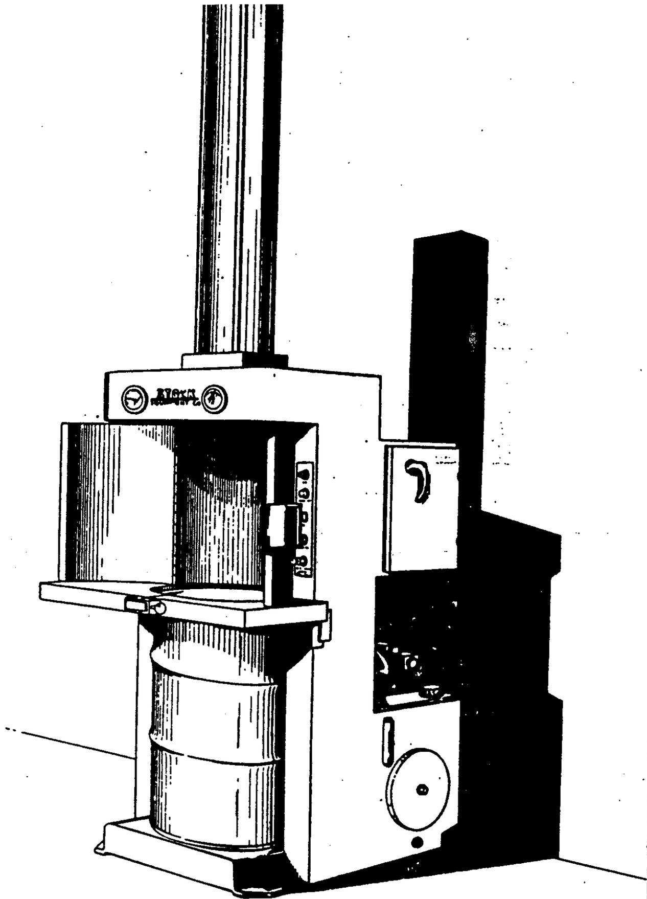
FIG. 13. DRY RADWASTE DRUM COMPACTOR
