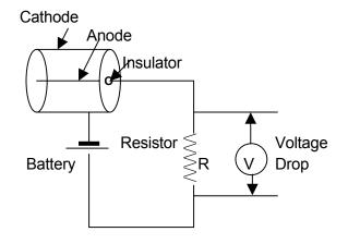
Fig. 6.4. Ion Chamber Circuit
