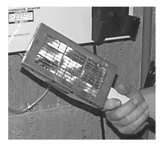
Fig.6.18. Thin-Window Detector Tube
