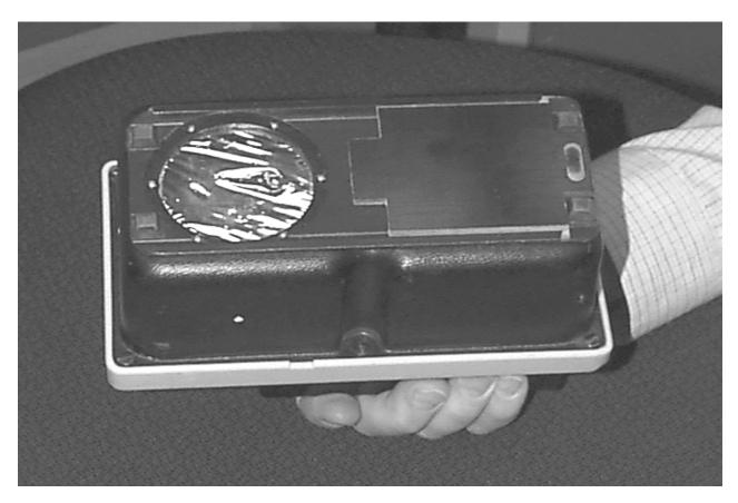
Fig. 6.17. Low-Range Beta Survey Meter (Bottom View)
