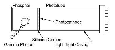
Fig. 6. 30. The Phosphor-Phototube Assembly
