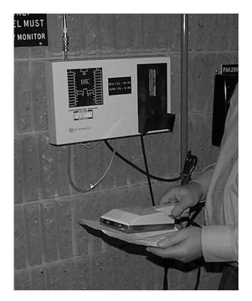
Fig. 6.10. Alpha/Beta-Gamma Contamination Meter
