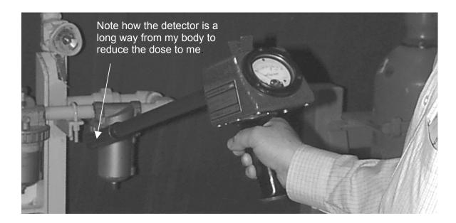
Fig. 6.5. Emergency Gamma Survey Meter
