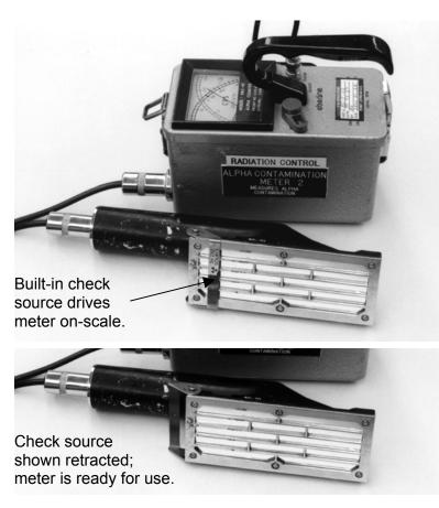
Fig. 6. 33. Alpha Contamination Meter
